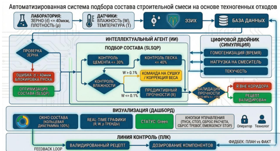
Рисунок 2. Блок схема алгоритма автоматизированного подбора состава строительной смеси на основе техногенных отходов.
